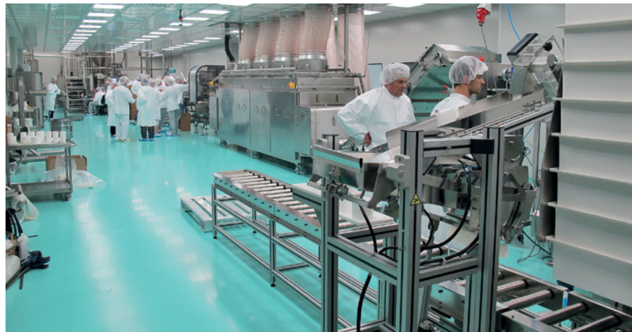
Zmogljivost proizvodne linije za pastile je do 600 kg pastil na uro.
